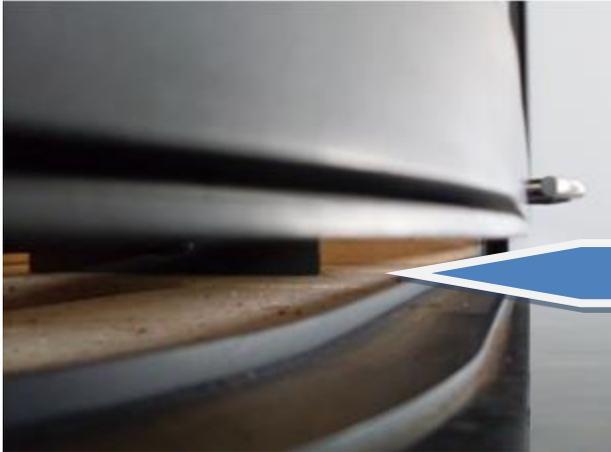
Le filet d'air pénétrant dans le foyer est accéléré par le passage réduit sous la porte.
